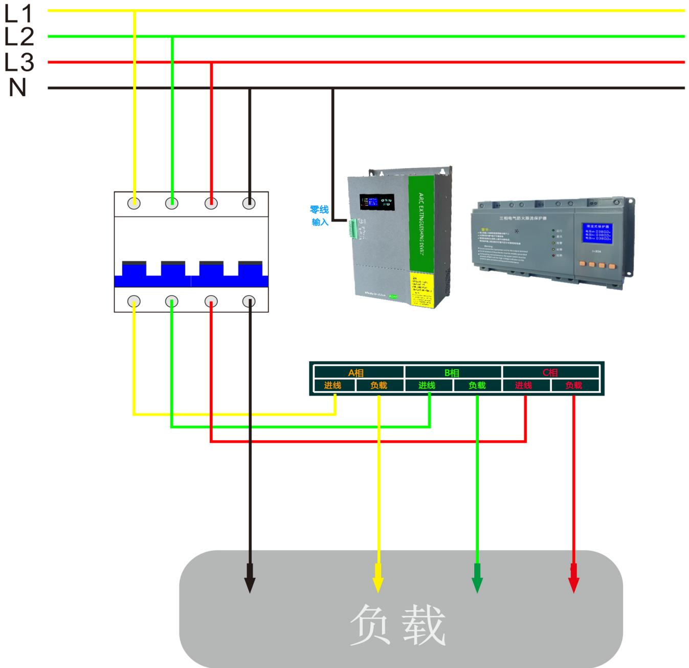
注意：保护器正确接线并上电后，液晶屏应显示正常运行界面，若投入负载运行过程中出现任何故障，可根据保护器的报警信息分析故障并进行故障排除。
