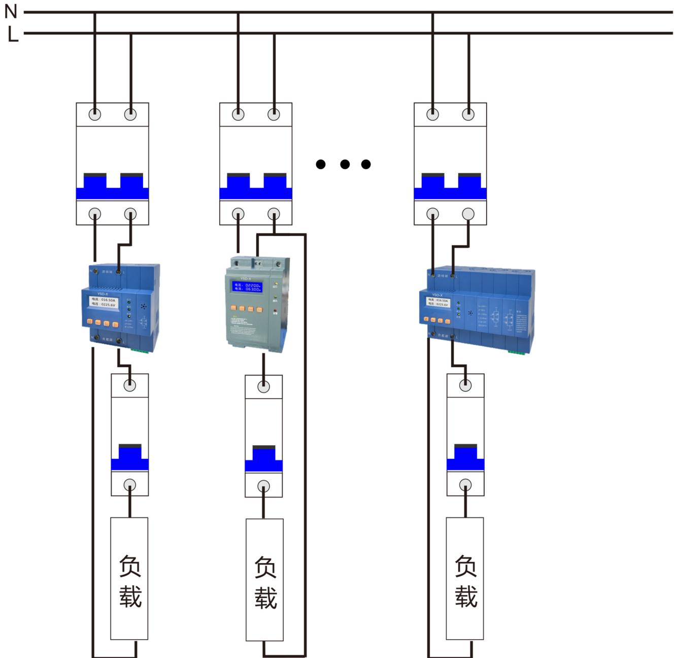
注意：保护器正确接线并上电后，液晶屏应显示正常运行界面，若投入负载运行过程中出现任何故障，可根据保护器的报警信息分析故障并进行故障排除。
